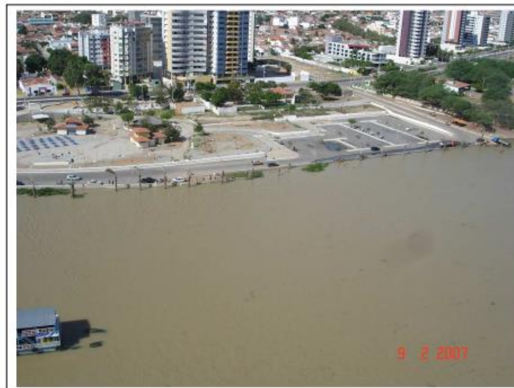
Foto 10 – Situação orla fluvial de Petrolina – PE, no dia 09/02/07, com vazão média diária de 6.083 m 3 /s, registrada pelo posto hidrométrico de Juazeiro – BA.
