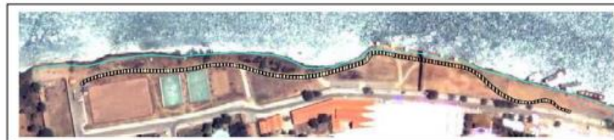
Figura 06 – Linha d'água referente à cota de 361,10 m, correspondente à vazão de 3.164 m 3 /s, sobre imagem do satélite QUICKBIRD .
