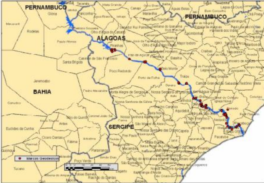
Figura 4 - Distribuição espacial dos marcos geodésicos implantados e rastreados.
