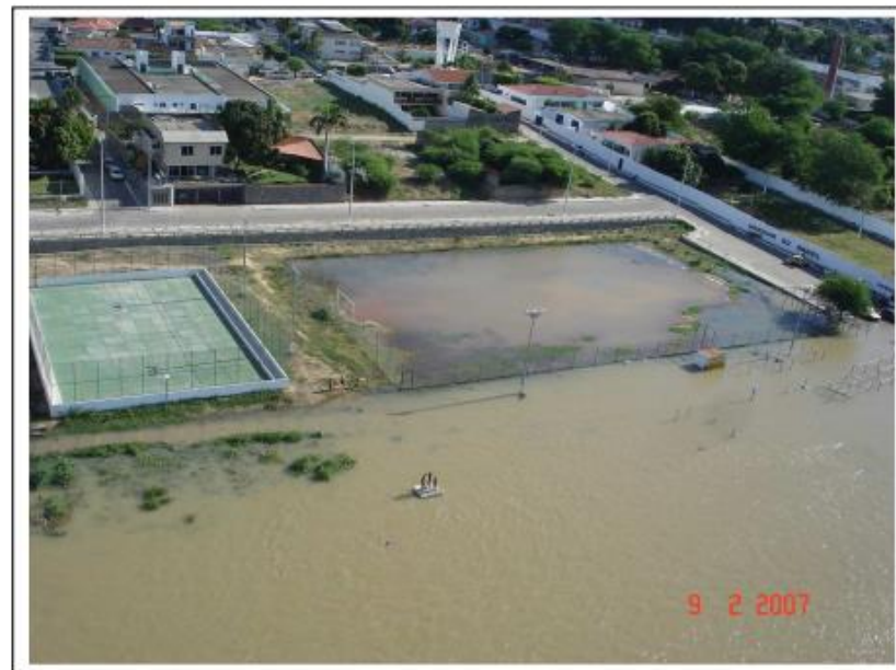
Foto 06 – Situação da orla fluvial no dia 09/02/2007, com vazão média diária de 6.083 m 3 /s, registrada pelo posto hidrométrico de Juazeiro – BA.
