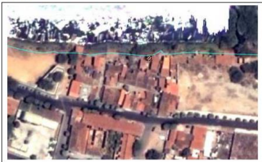
Figura 04 – Primeira residência do Angary alcançada pela linha da cota 361,75 m, correspondente à vazão de 4.106 \text{ m}^3/\text{s} , sobre imagem do satélite QUICKBIRD .
