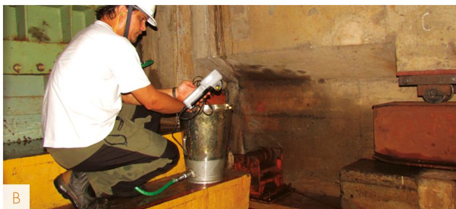
FIGURA 8 – Balde metálico com mangueira conectada ao seu fundo e à válvula do tubo de sucção (A) para medição de oxigênio dissolvido e temperatura (B).
