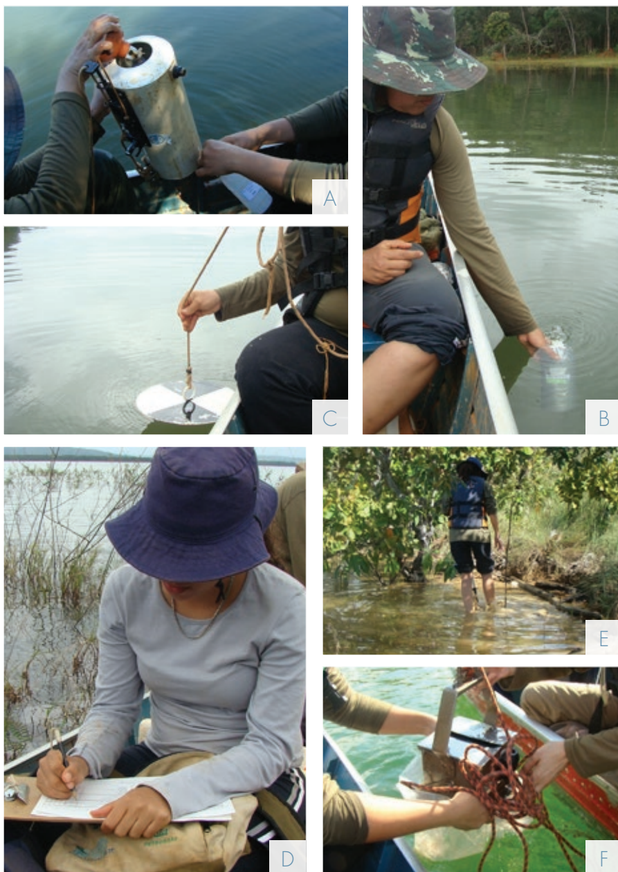
FIGURA 10 – Amostragem em reservatórios. Coleta de amostras de água (A; B; C), aplicação do protocolo de habitats físicos (D) e coleta de sedimento com os amostradores kick-net (E) e draga de Eckman-Birge (F).
