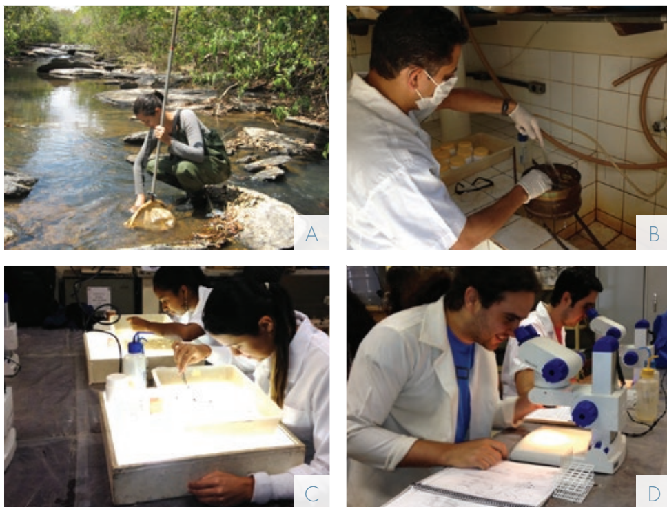
FIGURA 3 – Coleta de macroinvertebrados bentônicos utilizando o amostrador “kick-net” (A). Lavagem das amostras sobre peneira de 500 \mu\text{m} (B). Triagem em bandeja sobre caixas de luz (C). Identificação dos organismos em microscópio estereoscópico (D).
