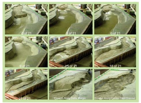
Figura 15. Estudo modelo de erosão de sedimentos
