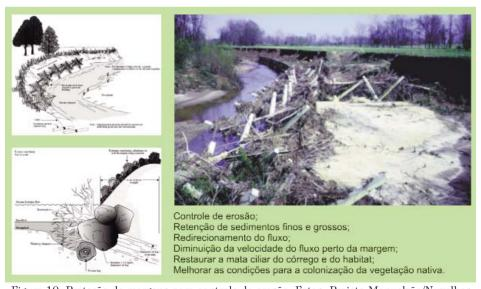
Figura 10. Proteção de margens para controle da erosão. Fotos: Projeto Manuelzão/Nuvelhas
