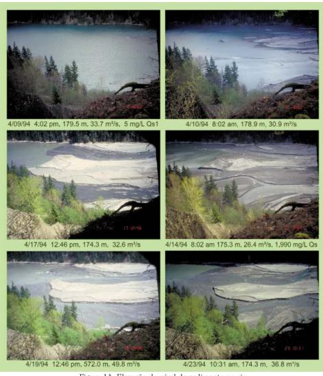
Figura 14. Elevação do nível de sedimento no rio
