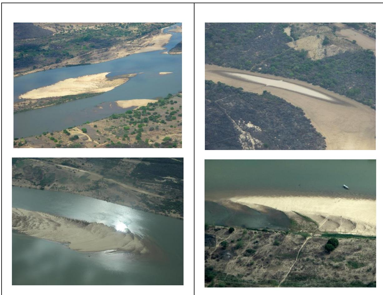
**Figura 7- Subtrecho ente Ibotirama e o Reservatório de Sobradinho - Assoreamento e o Surgimento de “Crôas” como Obstáculos à Navegação**
