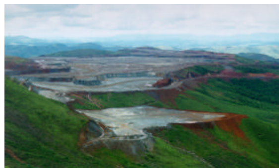
Foto 2. Mineração de ferro. Vistas da cava principal (esq) e da barragem de rejeitos (dir)
