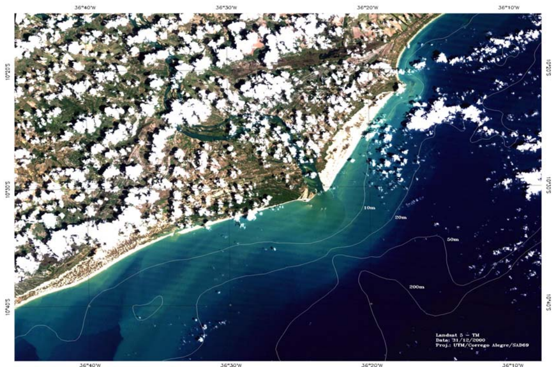
Figura 25. Sub-cena imagem TM LANDSAT, órbita ponto 214/67 da Foz do Rio São Francisco. Data: 31 de dezembro de 2000. Horário: 12:09:16 GMT. Composição colorida RGB (TM 3,2,1). Linhas sobre a água representam as isobatimétricas de 10, 20, 50 e 200 m.
