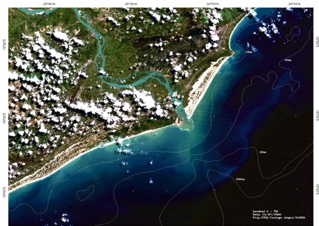
Figura 24. Sub-cena imagem TM LANDSAT, órbita ponto 214/67 da Foz do Rio São Francisco. Data: 24 de julho de 2000. Horário: 12:06:40 GMT. Composição colorida RGB (TM 3,2,1). Linhas sobre a água representam as isobatimétricas de 10, 20, 50 e 200 m.
