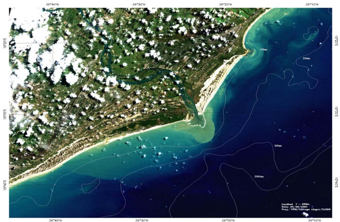
Figura 27. Sub-cena imagem TM LANDSAT, órbita ponto 214/67 da Foz do Rio São Francisco. Data: 05 de setembro de 2001. Horário: 12:18:09 GMT. Composição colorida RGB (TM 3,2,1). Linhas sobre a água representam as isobatimétricas de 10, 20, 50 e 200 m.
