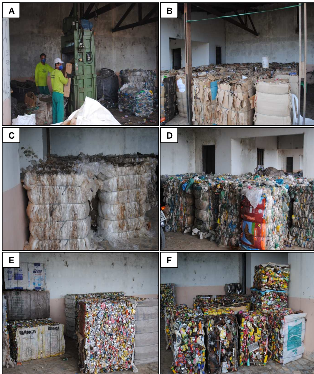
Figura 6.107 – Prensa e enfiamento dos materiais para comercialização. Fonte: DRZ Geotecnologia e Consultoria (2015).
