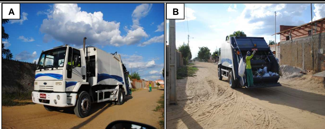
Figura 6.99 – Caminhão compactador utilizado na coleta domiciliar. Fonte: DRZ Geotecnologia e Consultoria (2015).
