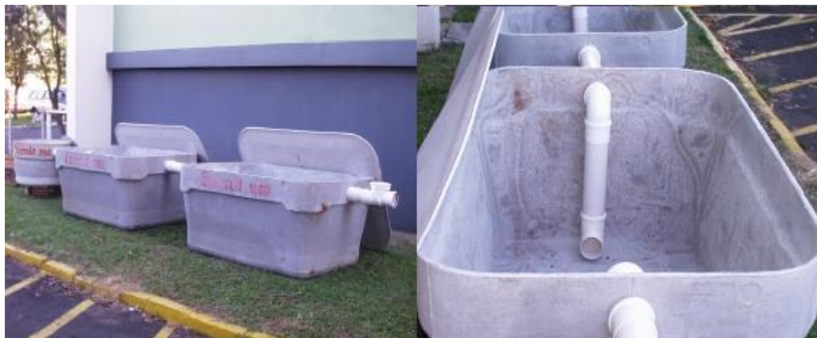
Figura 32: Biodigestor montado: vista lateral e vista superior.
