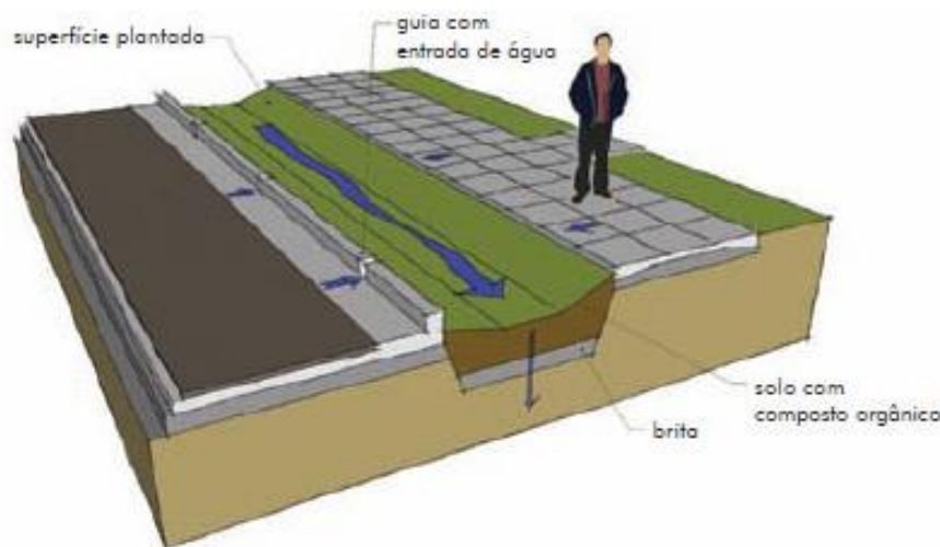
Figura 53: Esquema de Biovaleta
