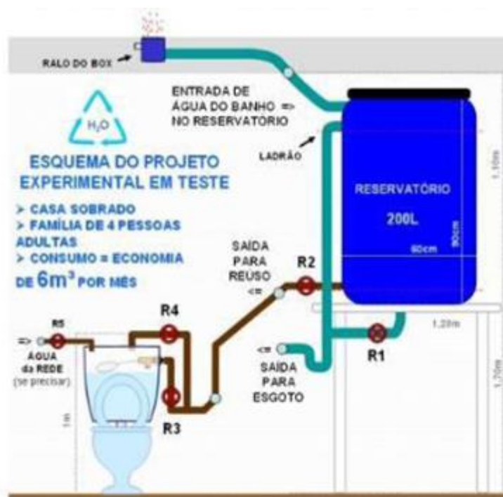
Figura 25: Esquema simplificado de reuso de efluente
