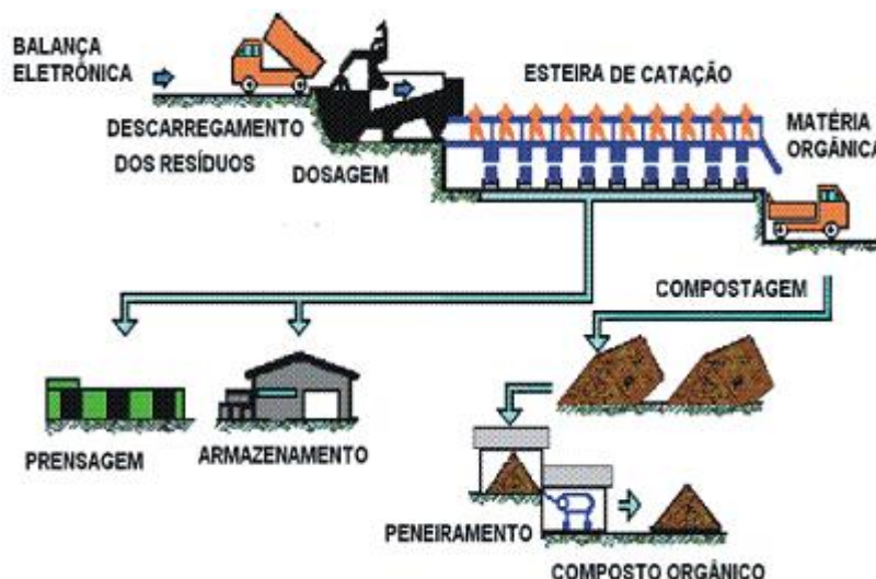
Figura 41: Fluxograma operacional da UTC
