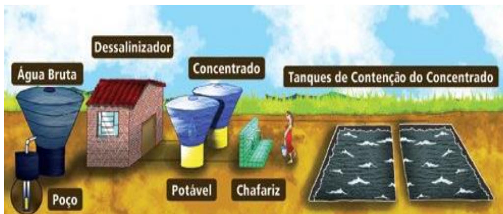
Figura 24: Sistema de dessalinização de águas subterrâneas Fonte: Ministério do Meio Ambiente, 2015
