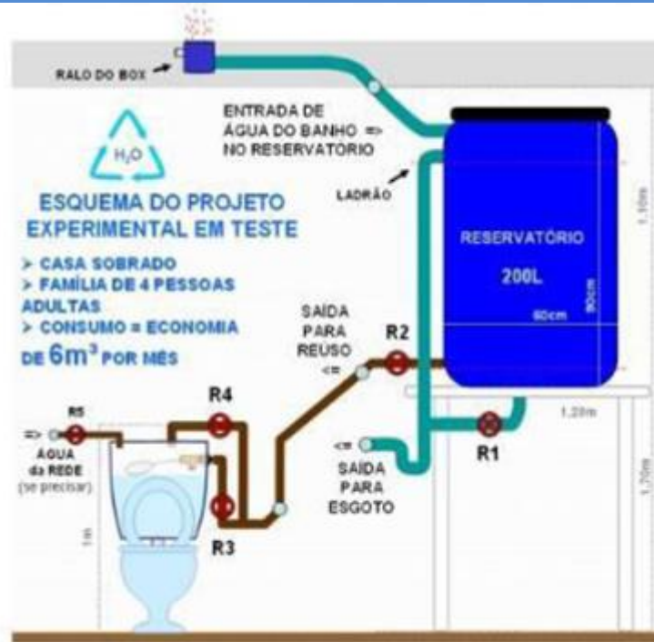
Figura 28: Esquema simplificado de reuso de efluente Fonte: Sociedade do Sol, 2013
