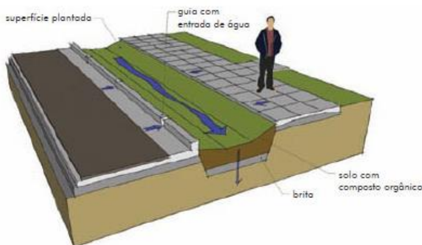
Figura 56: Esquema de Biovaleta Fonte: Cormier, 2014
