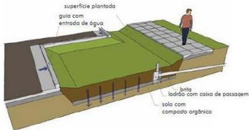
Figura 53: Esquema de um jardim de chuva Fonte: Cormier e Pellegrino (2008)
