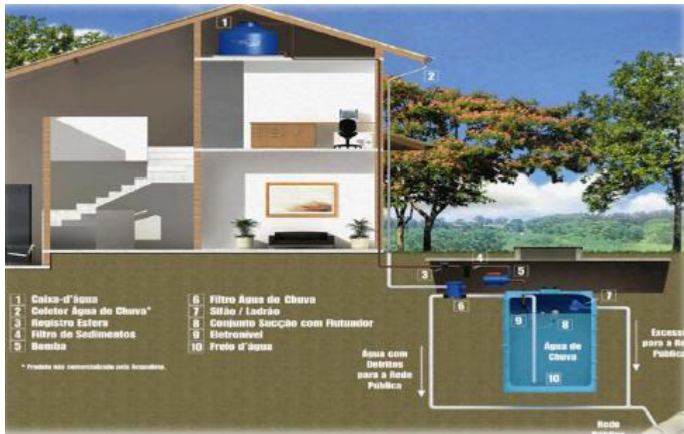
Figura 23: Esquema de captação de água de chuva Fonte: UFRN, 2012
