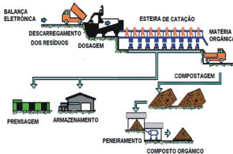
Figura 36: Fluxograma operacional da UTC Fonte: Porto Alegre, 2013.
