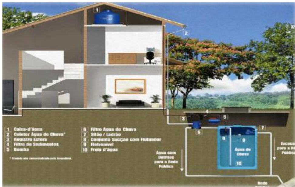
Figura 15: Esquema de captação de água de chuva
