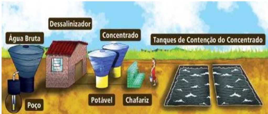
Figura 16: Sistema de dessalinização de águas subterrâneas
