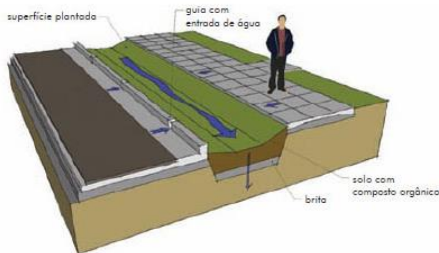
Figura 48: Esquema de Biovaleta Fonte: Cormier, 2014.
