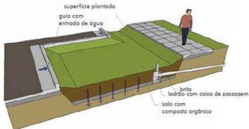
Figura 45: Esquema de um jardim de chuva Fonte: Cormier e Pellegrino (2008).
