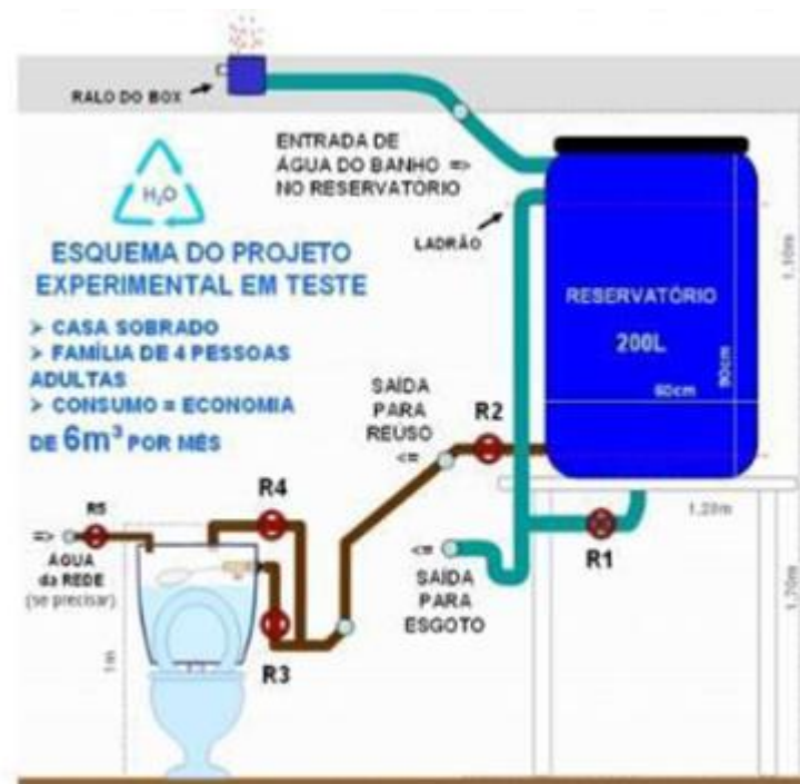
Figura 22: Esquema simplificado de reuso de efluente Fonte: Sociedade do Sol, 2013.
