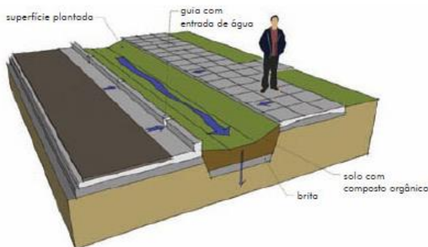
Figura 49: Esquema de Biovaleta Fonte: Cormier, 2014.
