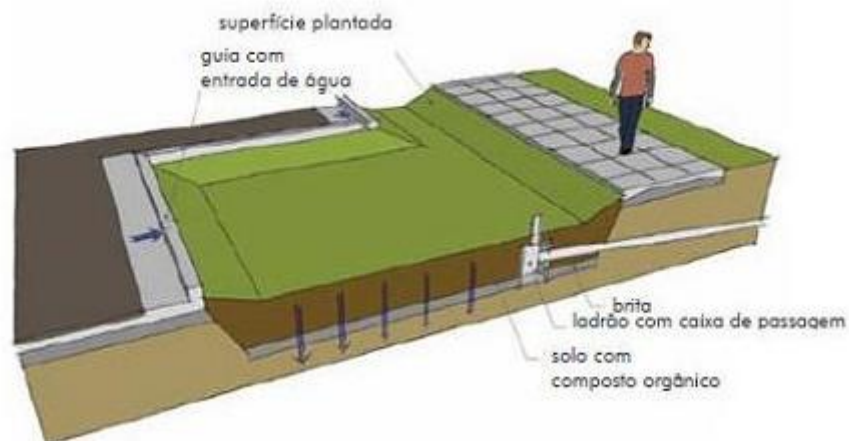
Figura 46: Esquema de um jardim de chuva Fonte: Cormier e Pellegrino (2008).
