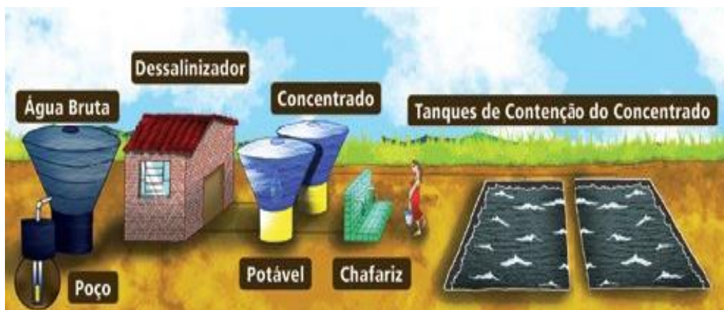
Figura 18: Sistema de dessalinização de águas subterrâneas
