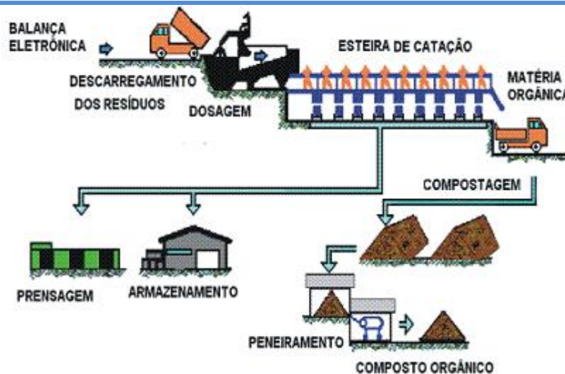
Figura 37: Fluxograma operacional da UTC Fonte: Porto Alegre, 2013.
