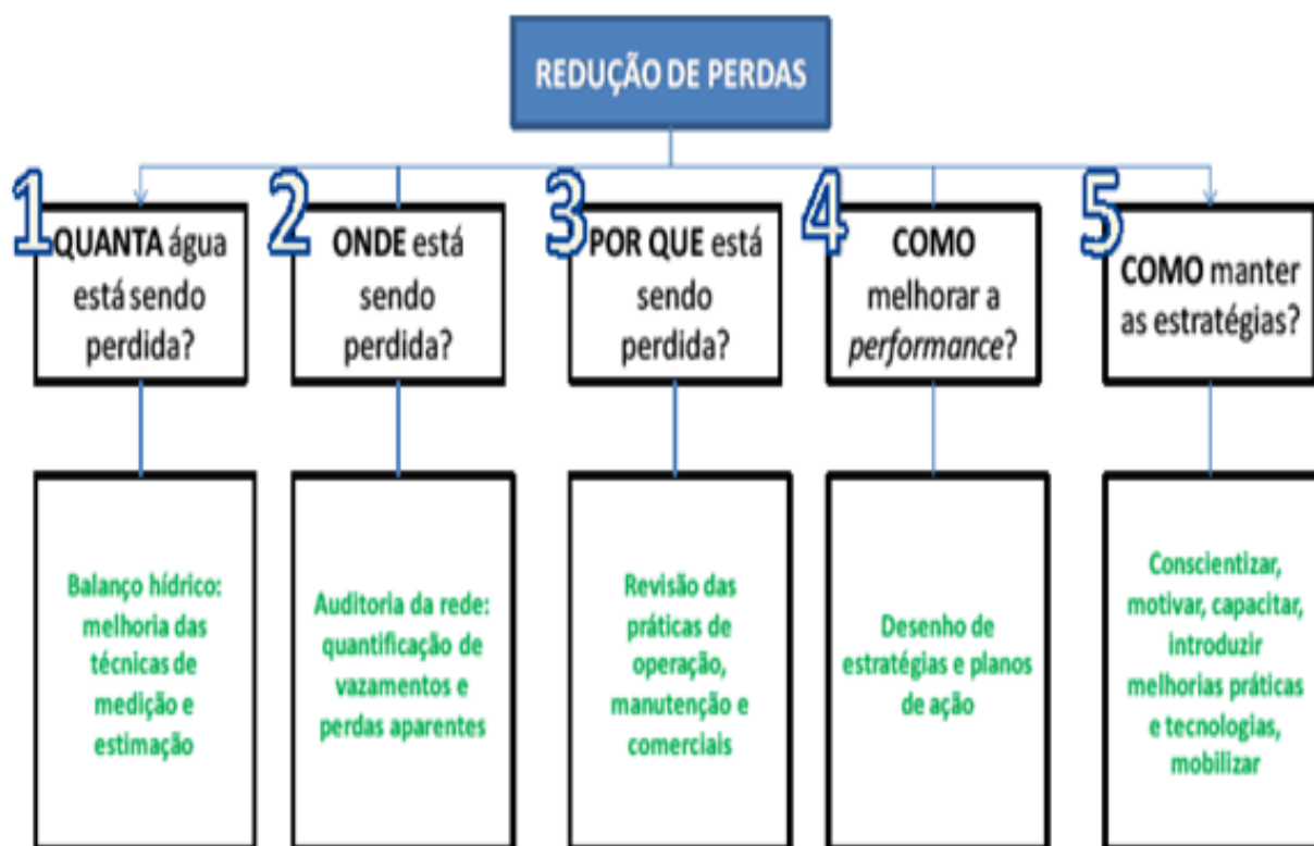
Figura 19: Modelo de avaliação e controle de perdas em sistemas de abastecimento de água
