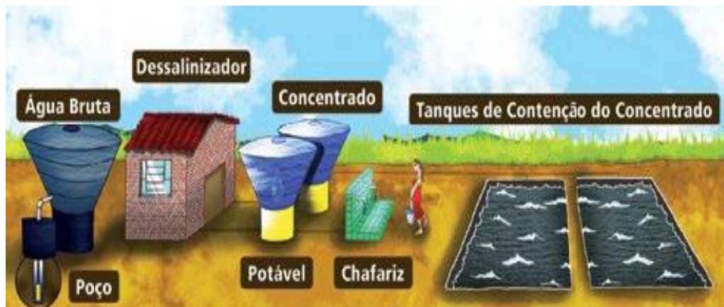
Figura 25: Sistema de dessalinização de águas subterrâneas
