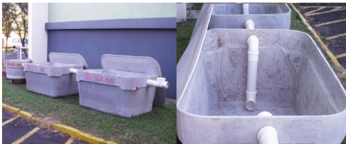
Figura 37: Biodigestor montado: vista lateral e vista superior. Fonte: Embrapa, 2010
