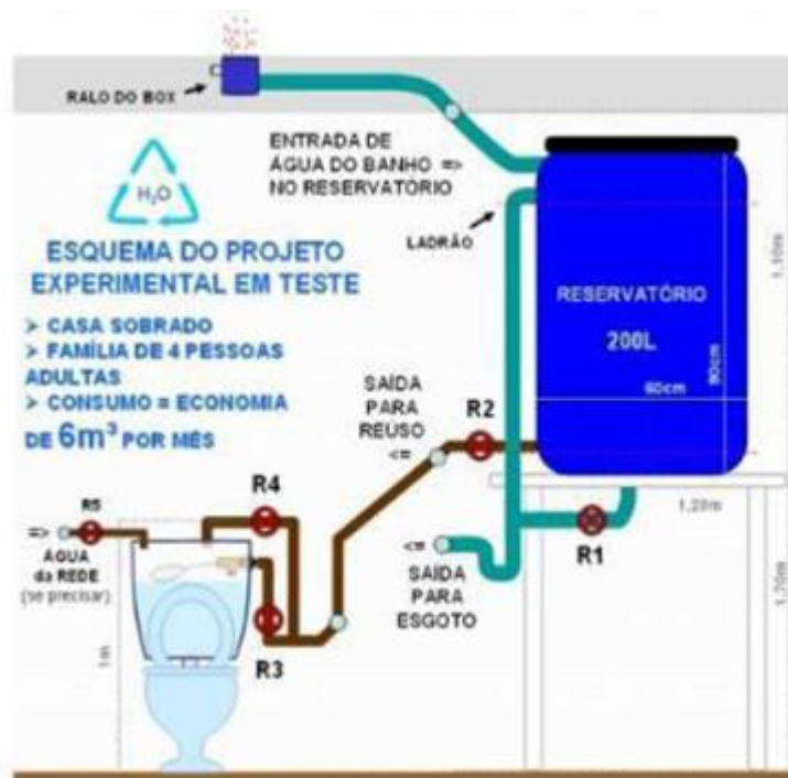
Figura 30: Esquema simplificado de reuso de efluente Fonte: Sociedade do Sol, 2013
