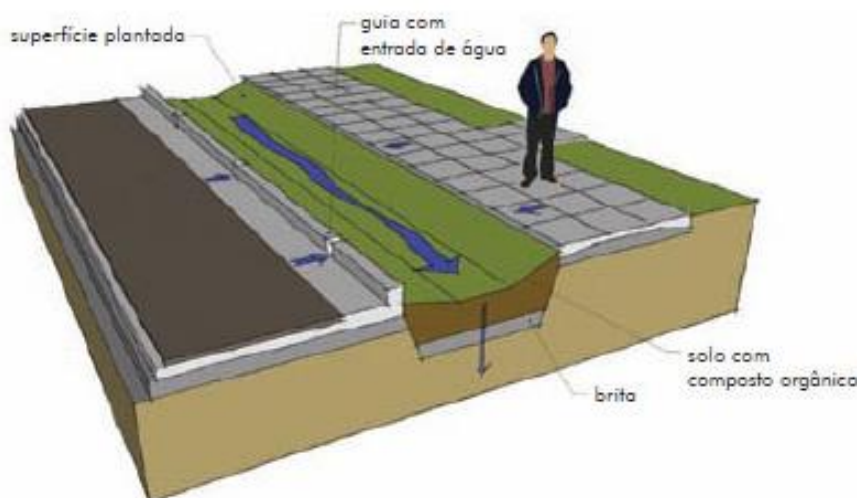
Figura 58: Esquema de Biovaleta Fonte: Cormier, 2014
