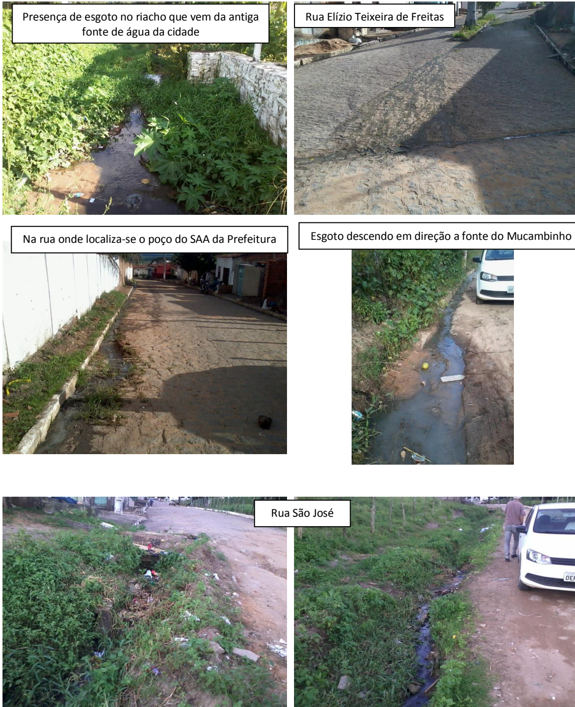
Figura 138: Esgoto a céu aberto em diversas ruas de Feira Grande. Fonte: Gesois, 2014.
