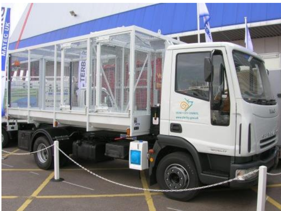
Figura 8.4 – Modelo de VUC para a coleta seletiva
