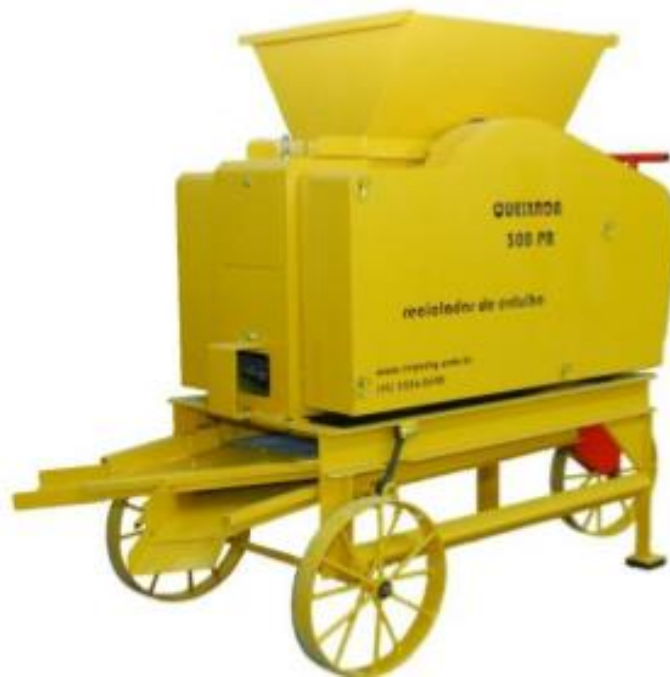
Figura 8.16 – Modelo de Reciclador de RCC
