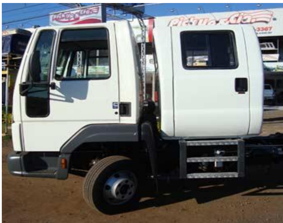
Figura 9.8 – Exemplo de módulo auxiliar para transporte de funcionários adaptado em caminhão
