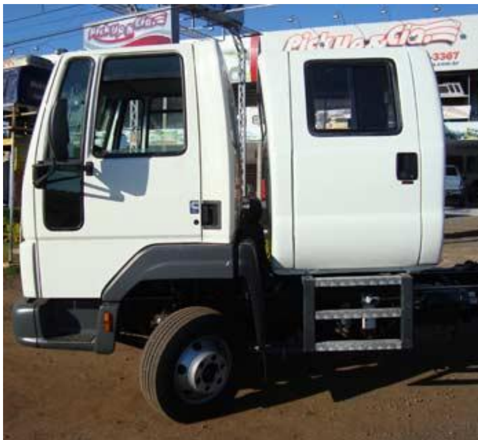
Figura 9.11 – Exemplo de módulo auxiliar para transporte de funcionários adaptado em caminhão
