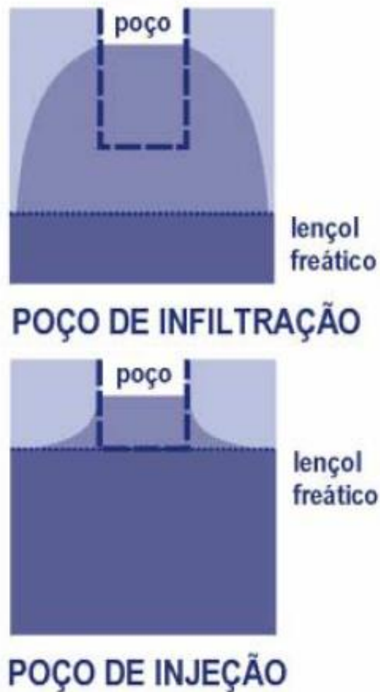
Figura 10.12 – Poço de infiltração e poço de injeção
