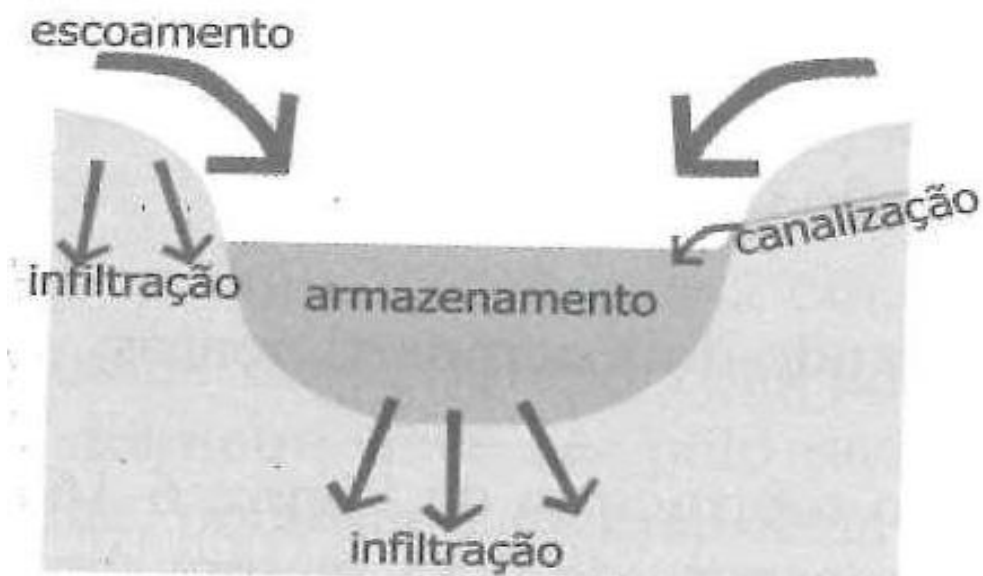
Figura 10.5 – Vala de infiltração
