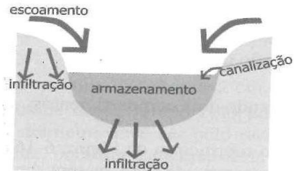
Figura– Vala de infiltração
