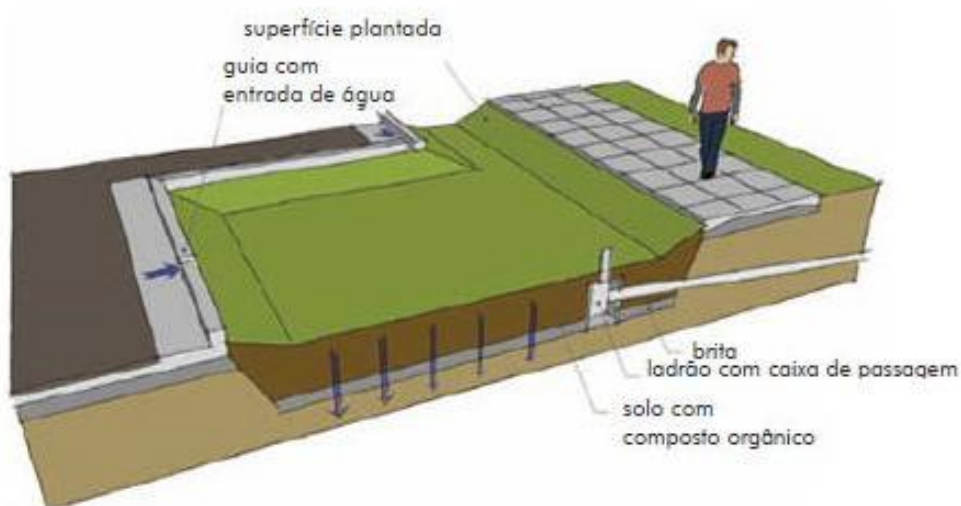
Figura 11.8 – Esquema de um jardim de chuva
