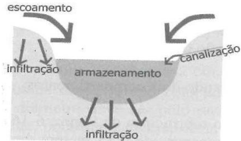
Figura 11.5 – Vala de infiltração
