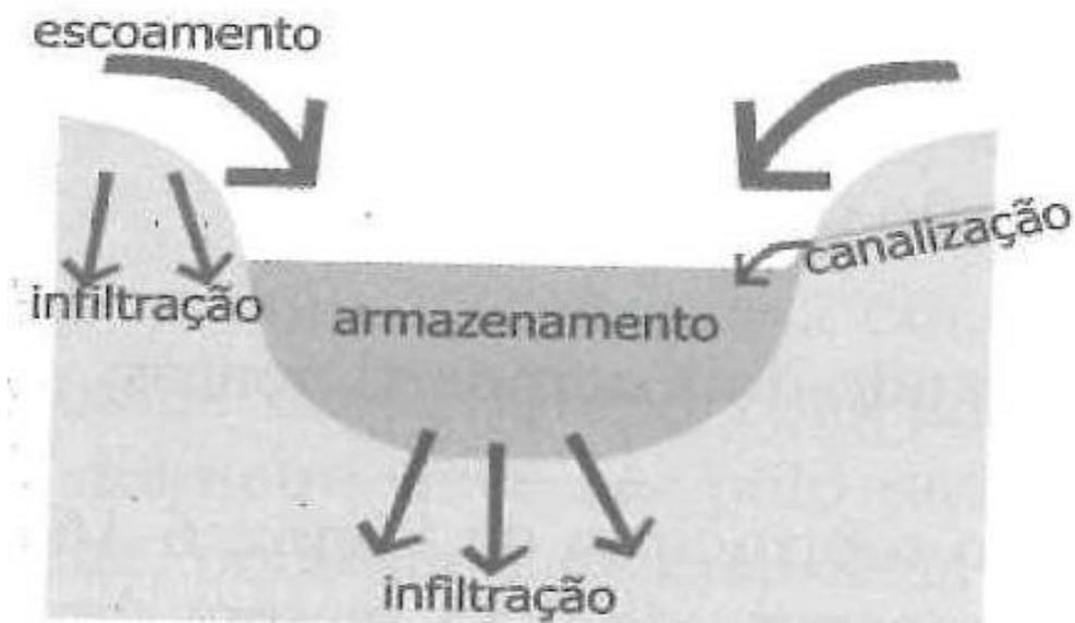
**Figura 11.5 – Vala de infiltração**
