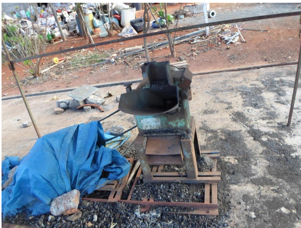
Figura 7.171 – Máquina trituradora para compostagem na UTC Papagaios
