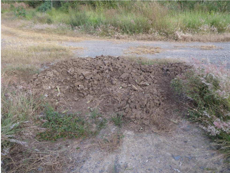
Figura 7.103 – Lodo da ETE para disposição final
