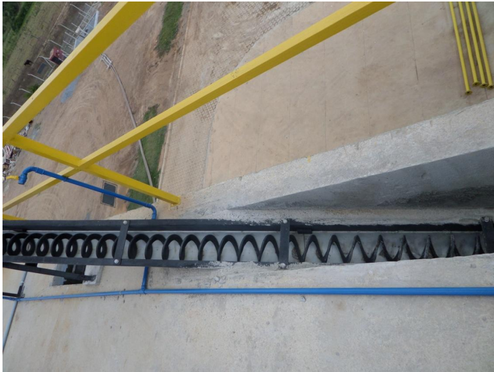
Figura 8.115–Mecanismo de transporte do tipo parafuso
