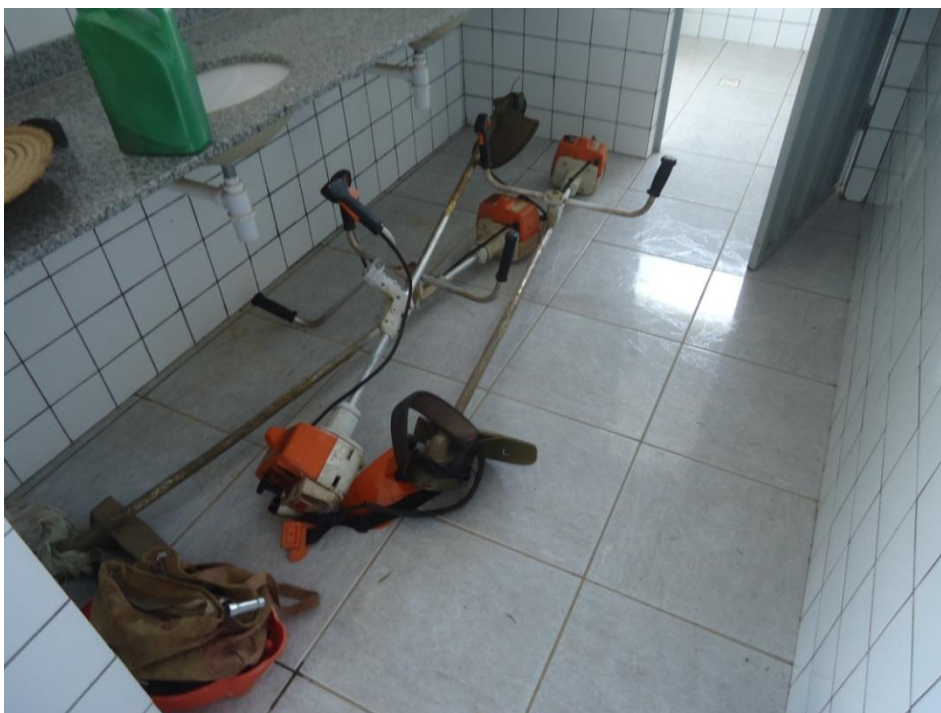
Figura 8.170 - Equipamento utilizado para realização da capina
