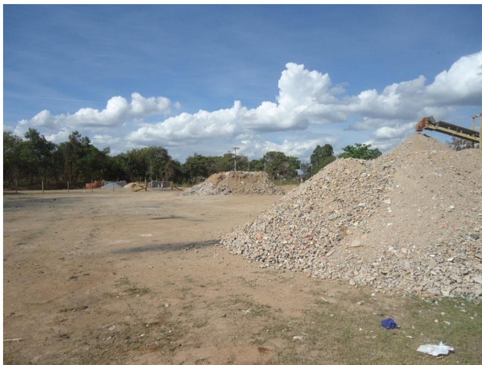
Figura 8.180 – Área de triagem dos RCC coletados pela empresa privada
