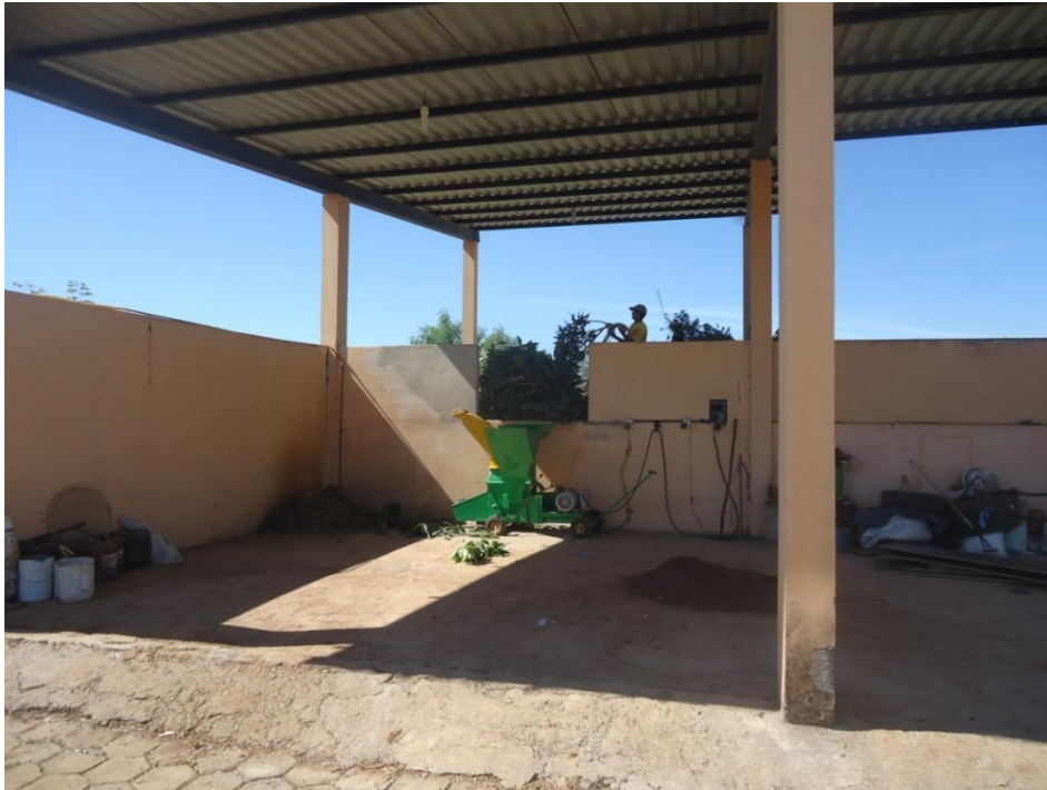
Figura 8.210 – Triturador de resíduos com destino à usina de compostagem
