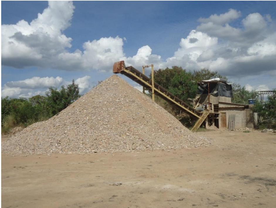
Figura 8.181 –RCC triturado pela empresa privada
