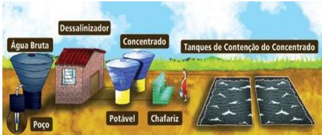
Figura 54: Sistema de dessalinização de águas subterrâneas
