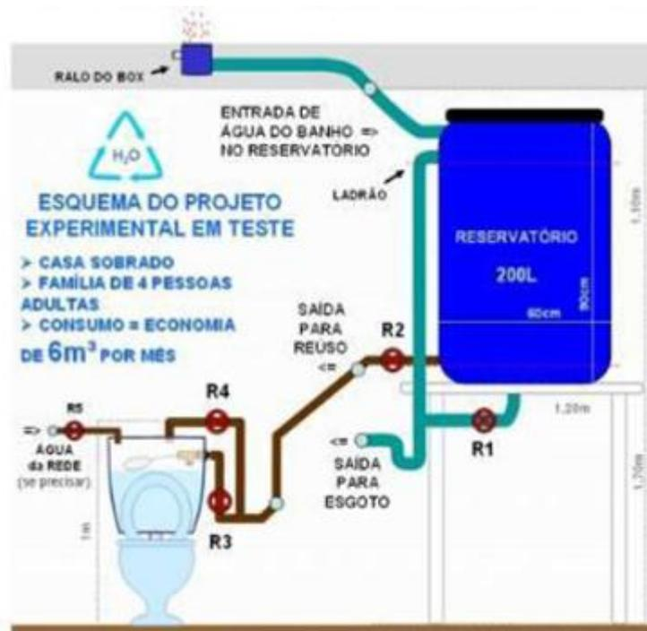
Figura 58: Esquema simplificado de reuso de efluente
