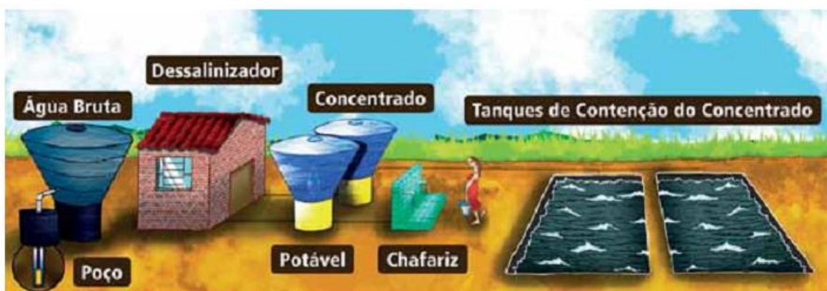
Figura 119: Croqui do Sistema de Dessalinização do PAD.
