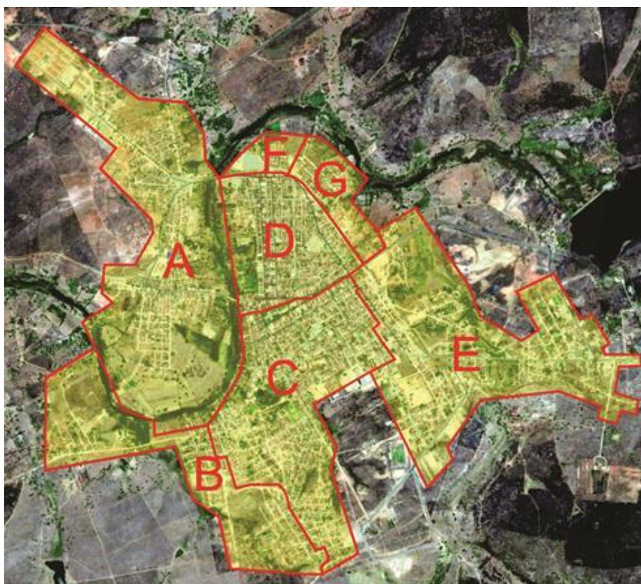
Figura 226: Divisão das bacias de esgotamento. LHS CONSULTORIA, 2012.
