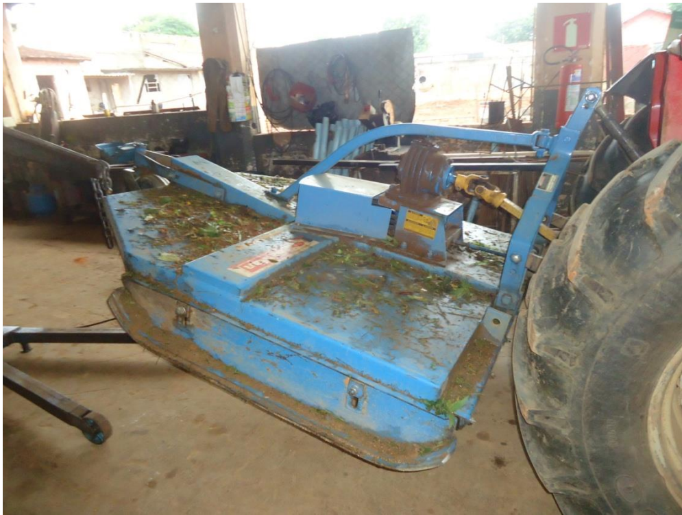
Figura 8.134 – Trator com roçadeira para realização da limpeza de lotes vagos
