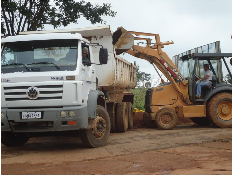
Figura 8.129 – Trator retroescavadeira e caminhão basculante realizando a coleta dos resíduos derivados da capina
