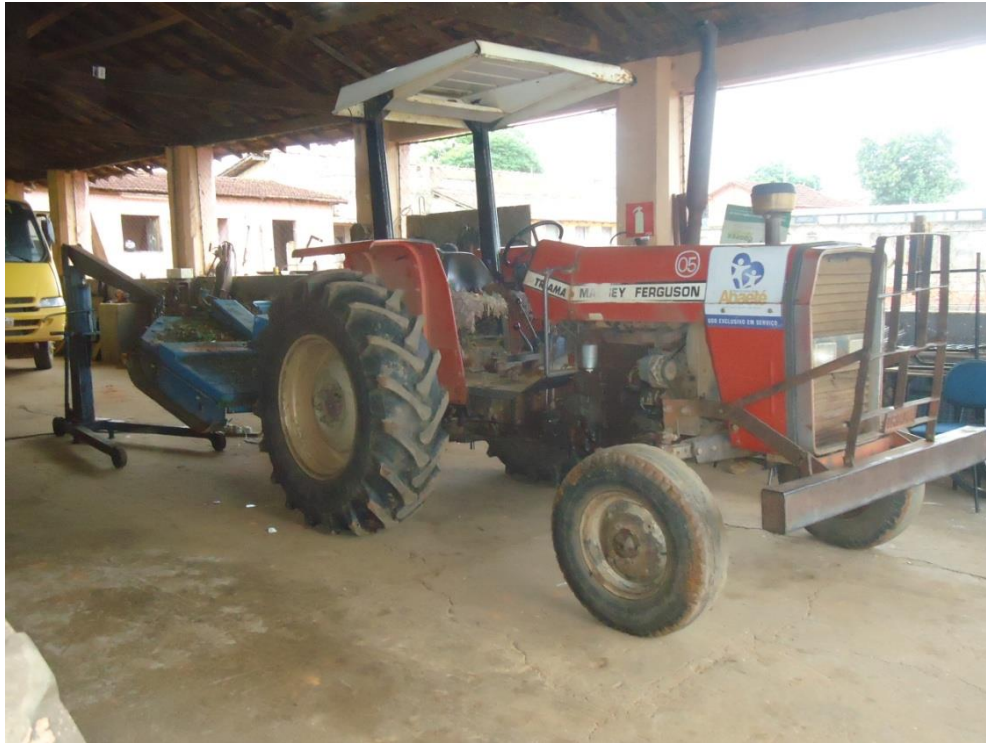
Figura 8.133 – Trator com roçadeira para realização da limpeza de lotes vagos
