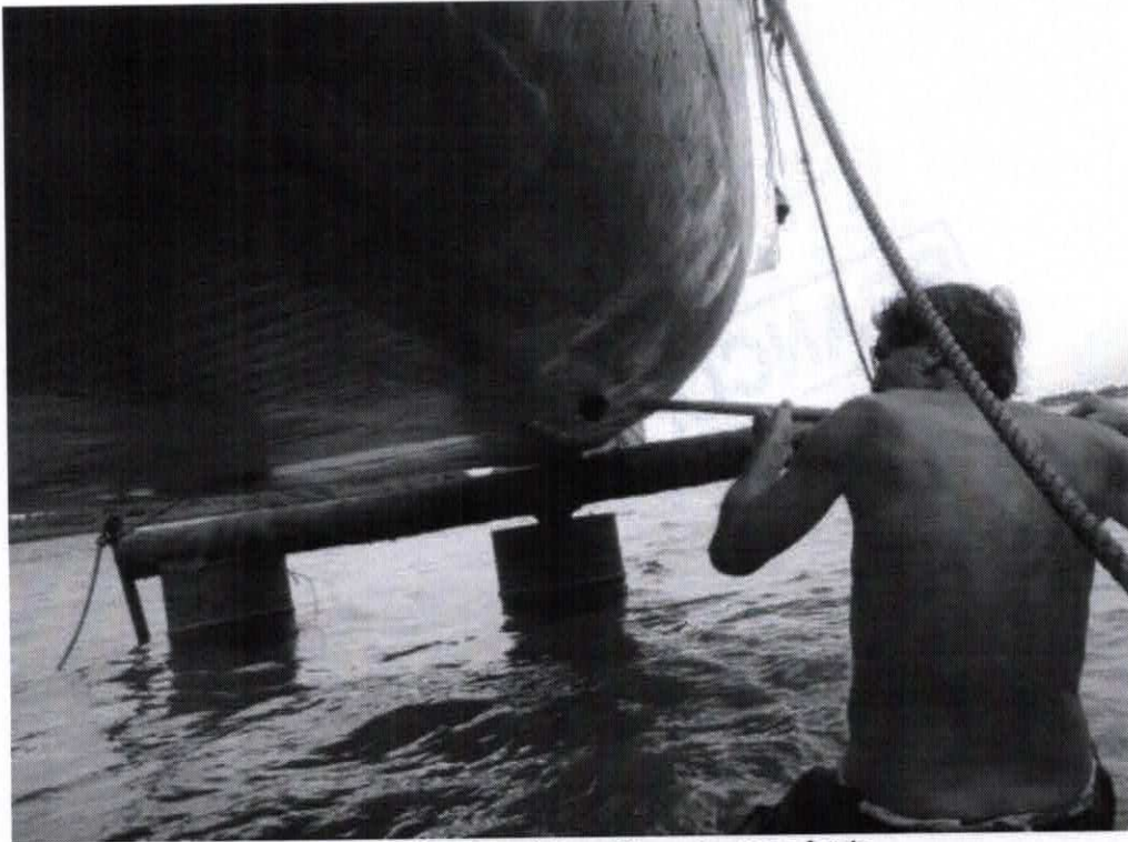
Figura 9 - Aplicando a tinta antiincrustante no fundo.
