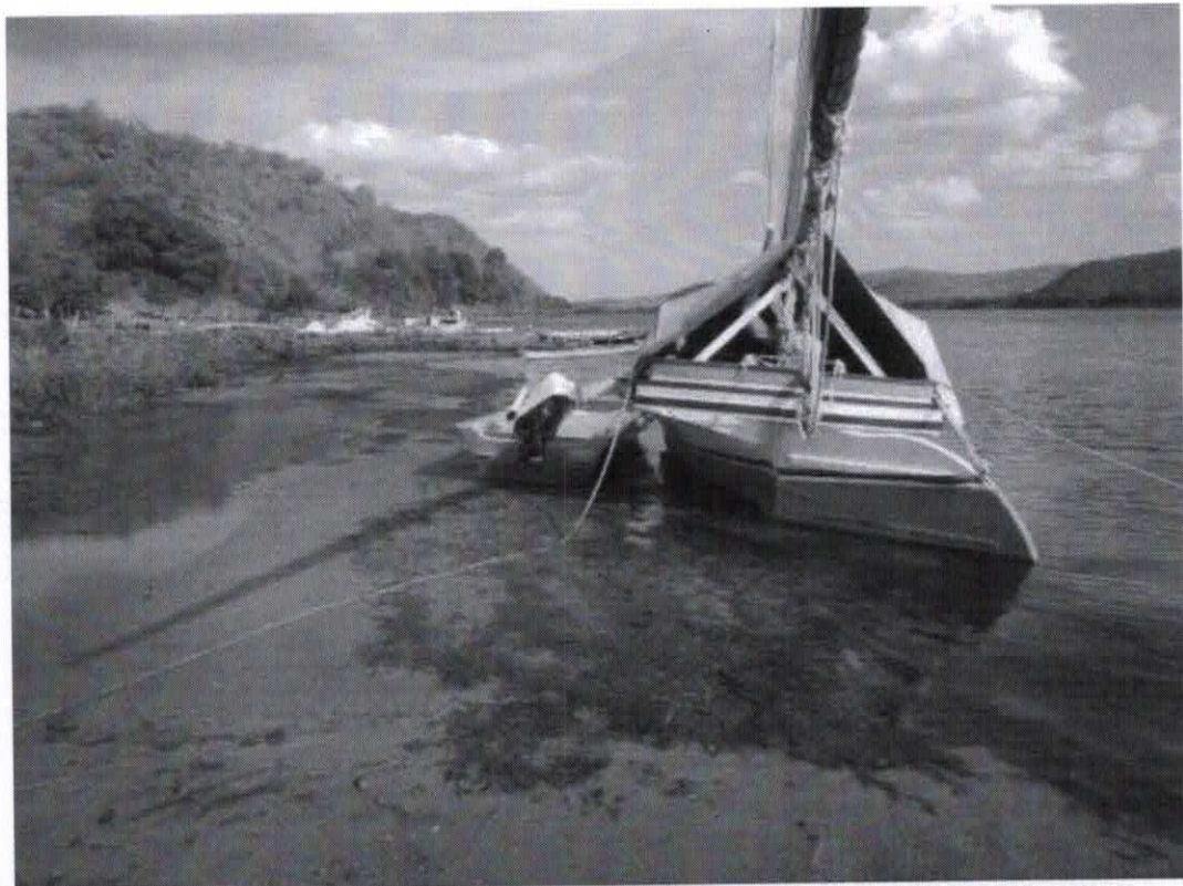
Figura 14 - Observar o calado da Luzitânia, cerca de 500 mm até a ponta do leme, carga leve.
