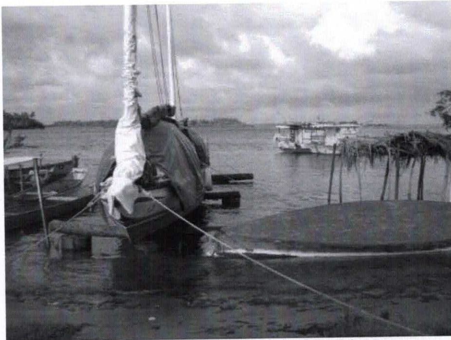
Figura 5 - A maré secando deixa os calços, de coqueiros, à mostra.
