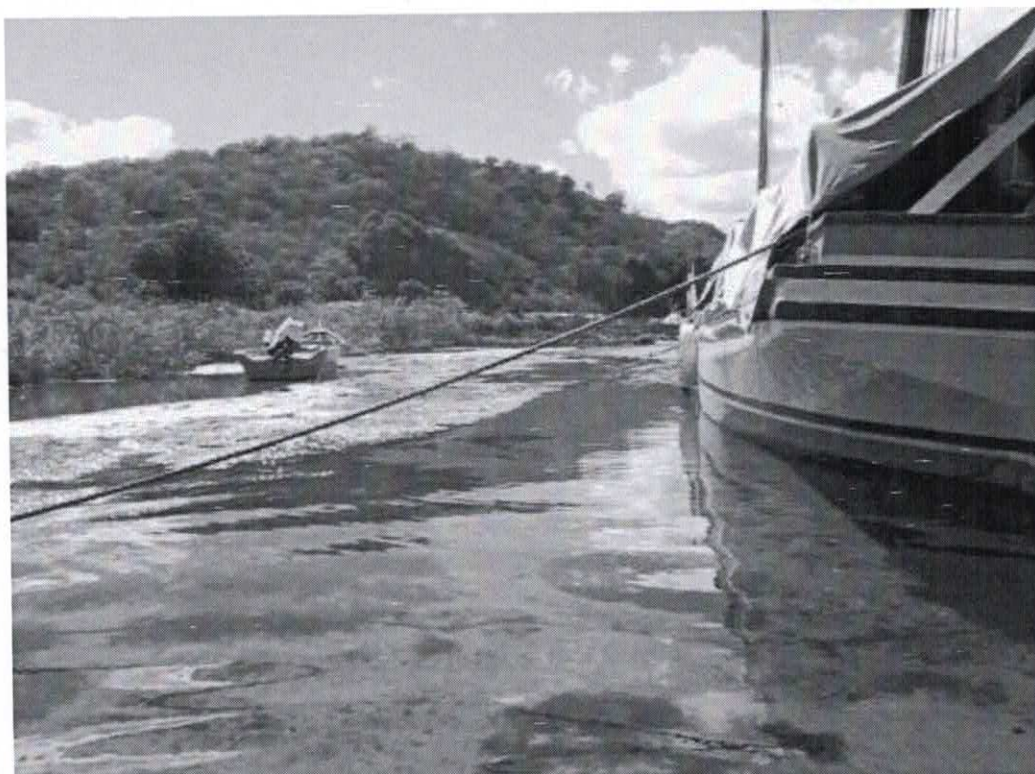
Figura 7 – Observar a marca linha d'água no casco da Luzitânia, onde há uma diferença de aproximadamente 90 mm (a serem adicionados a aproximadamente outros 100, compondo a variação de cerca de 150 a 190 mm de lâmina d'água por 100 m 3 /s nesta região).
