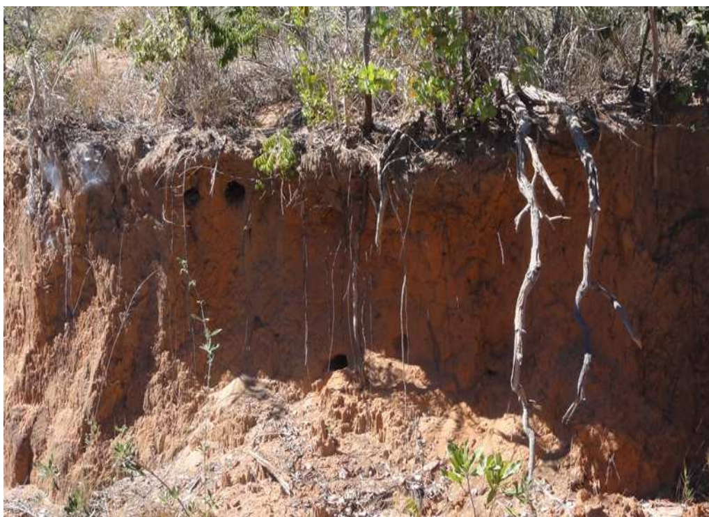
Fotografia 2 – Detalhe do perfil de solo e raízes da vegetação nativa na borda da voçoroca.
