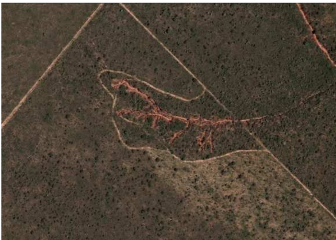
Imagem de Satélite 4: detalhes de desvio da estrada interrompida pela voçoroca.
