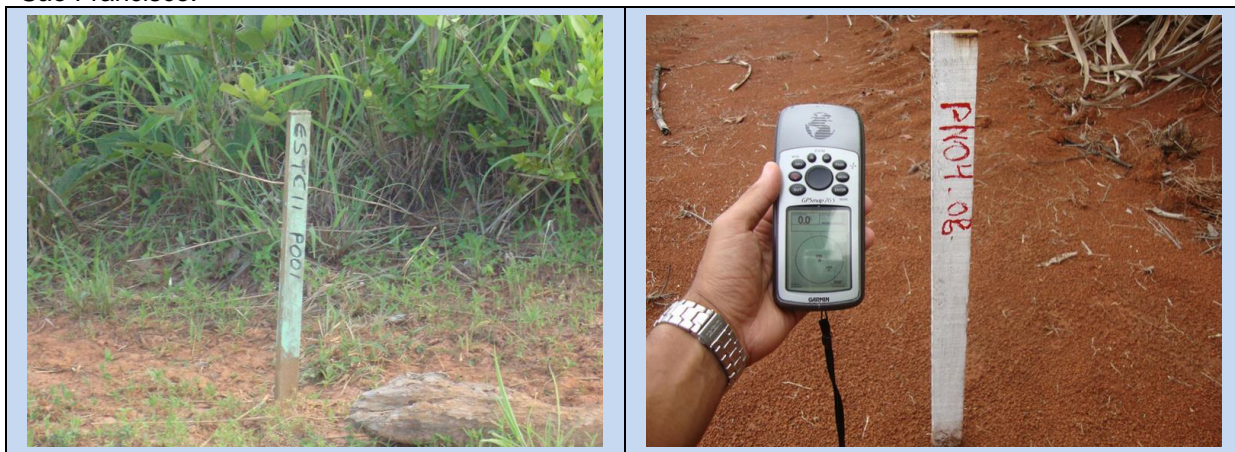
Figura 7.12 - Locação topográfica de projetos hidroambientais na bacia do rio São Francisco. Vale destacar que, após a execução das intervenções, a exemplo da finalização da cerca da APP1 e/ou término da adequação da Estrada Rural 1, a equipe de topografia deverá fazer o levantamento dos dados para a elaboração do "as built".
