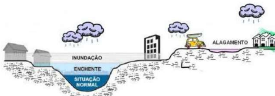
Figura 4-164- Ilustração dos conceitos de enchente, inundação e alagamento
