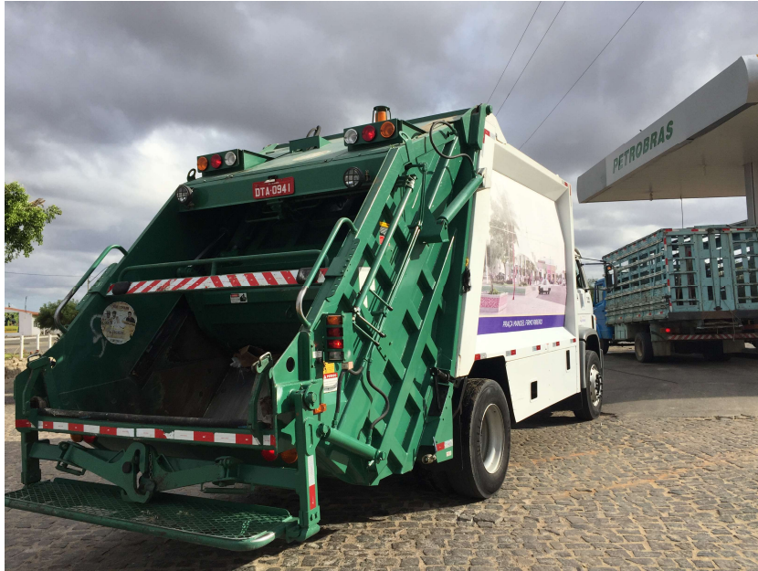
Figura 4-109 – Caminhão terceirizado utilizado para coleta de RSD no município de Remanso
