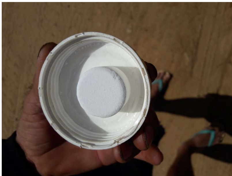
Figura 4-60 - Tablete efervescente para desinfecção colocado no caminhão pipa Fonte: Projeta Engenharia (2017)
