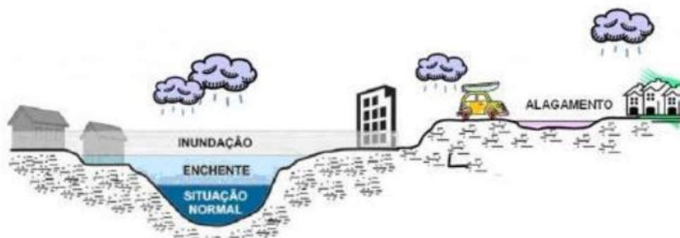
Figura 4-135 - Ilustração dos conceitos de enchente, inundação e alagamento
