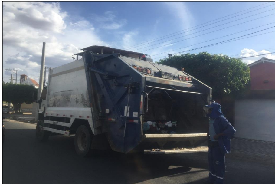
Figura 60 – Caminhão compactador utilizados para a coleta de resíduos domiciliares. Fonte: DRZ – Geotecnia e Consultoria, 2017.
