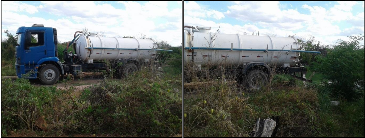
Figura 47 – Caminhão de limpeza, desobstrução da rede de esgoto e despejo irregular de esgoto doméstico na lagoa.
