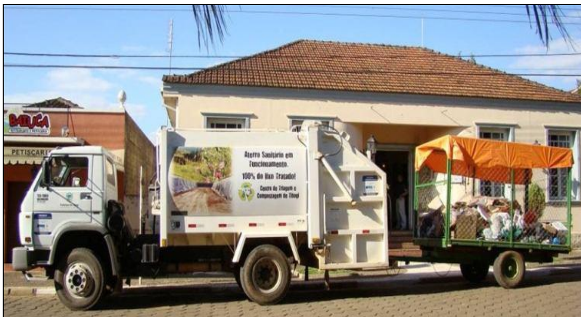
Figura 7 – Carroceria adaptada para coleta seletiva. Fonte: Prefeitura Municipal de Tibagi.
