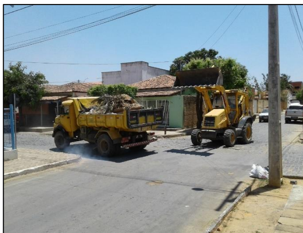
Figura 82 - Caminhão caçamba e retroescavadeira utilizados na coleta de entulhos Fonte: DRZ – Geotecnologia e Consultoria, 2017.
