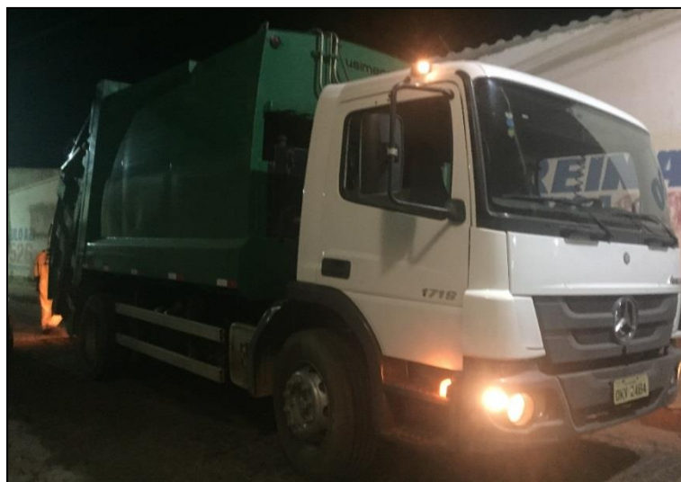
Figura 103 – Caminhão compactador utilizado para a coleta de resíduos domiciliares.
