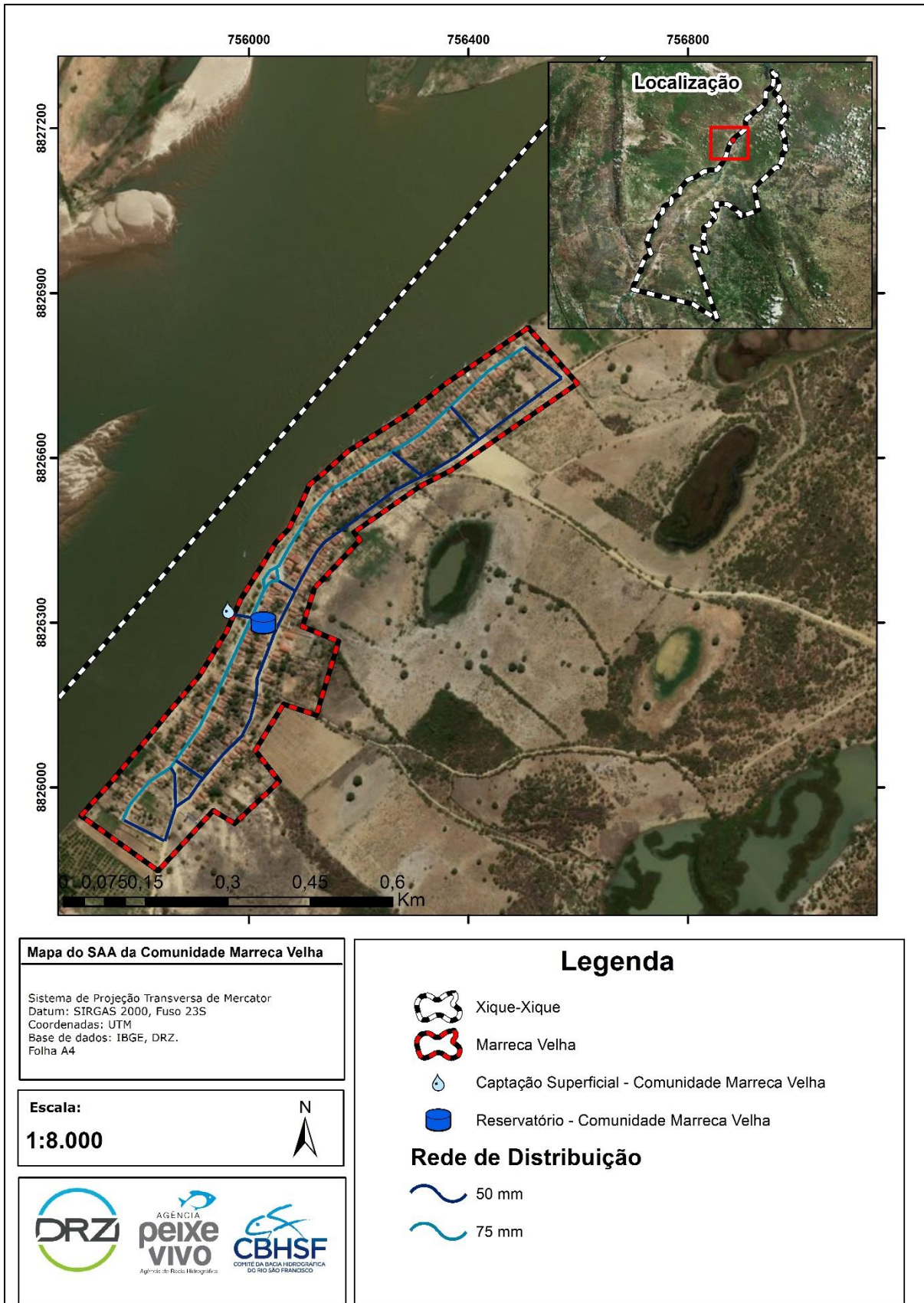
Figura 61 – Sistema de abastecimento de água da comunidade Marreca Velha. Fonte: DRZ – Geotecnologia e Consultoria, 2018.
