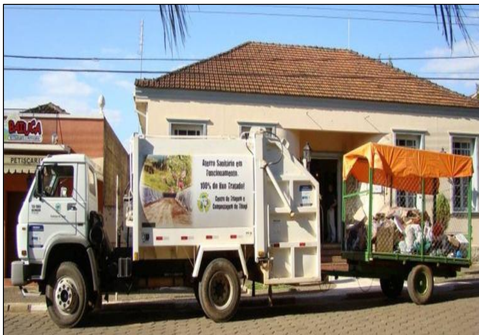
Figura 12 – Carroceria adaptada para coleta seletiva. Fonte: Prefeitura Municipal de Tibagi.
