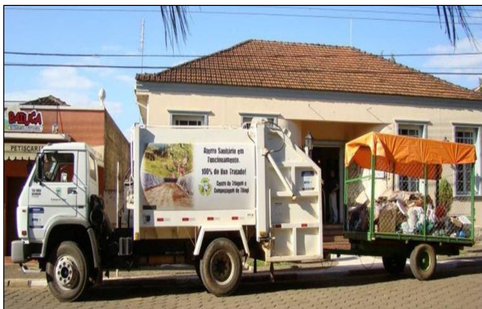
Figura 9 – Carroceria adaptada para coleta seletiva. Fonte: Prefeitura Municipal de Tibagi.
