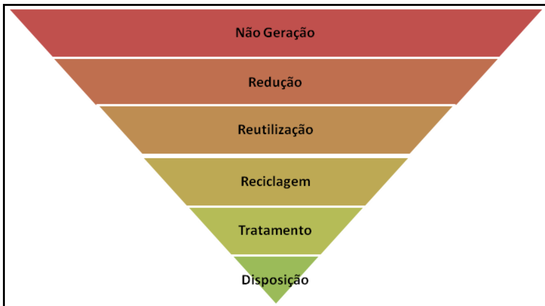
Figura 4 – Prioridades na gestão dos resíduos sólidos (preconizado na PNRS) Fonte: Premier Engenharia, 2017.
