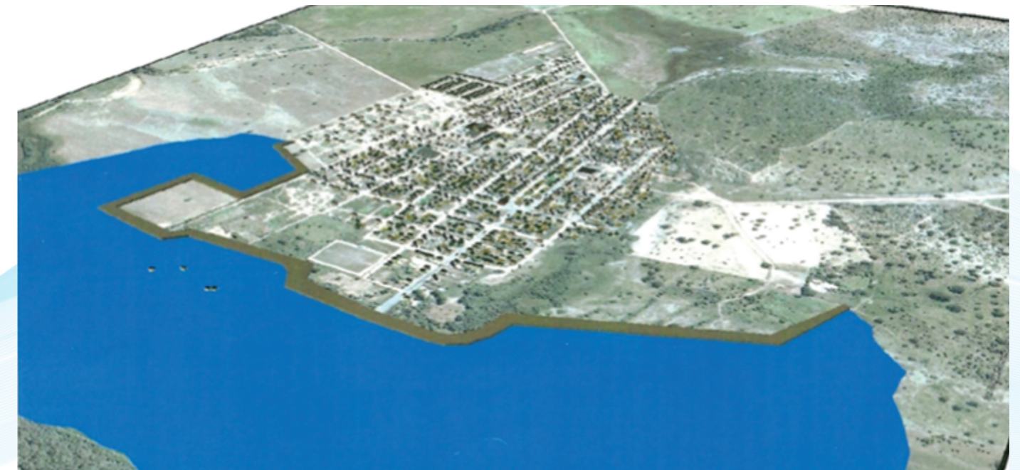
Figura 63 – Imagem do Município de Ponto Chique com Evento da Cheia e com o Dique Fonte: CODEVASF, 2015
