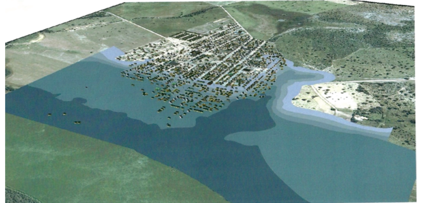
Figura 62 – Imagem do Município de Ponto Chique com Evento da Cheia e sem o Dique Fonte: CODEVASF, 2015
