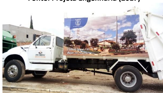
Figura 39 – Caminhão compactador terceirizado, utilizado para coleta de RSD nos distritos, povoados e terrenos baldios da sede Fonte: Projeta Engenharia (2017)
