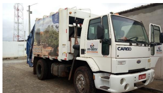
Figura 38 – Caminhão compactador terceirizado, utilizado para coleta de RSD na sede do município de Lapão Fonte: Projeta Engenharia (2017)
