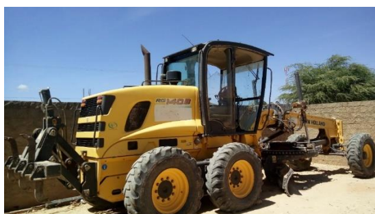
Figura 5-41 – Patrol Motoniveladora da Prefeitura Municipal de Itaguaçu da Bahia Fonte: Projeta Engenharia (2017)
