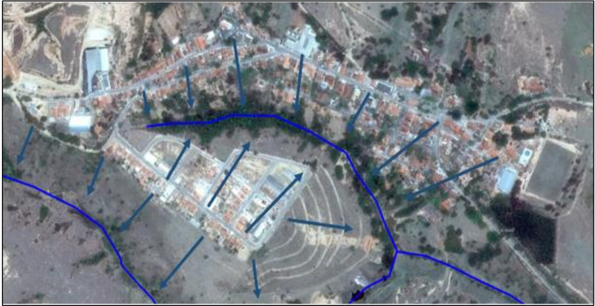
Figura 105: escoamento da água superficial na sede municipal
