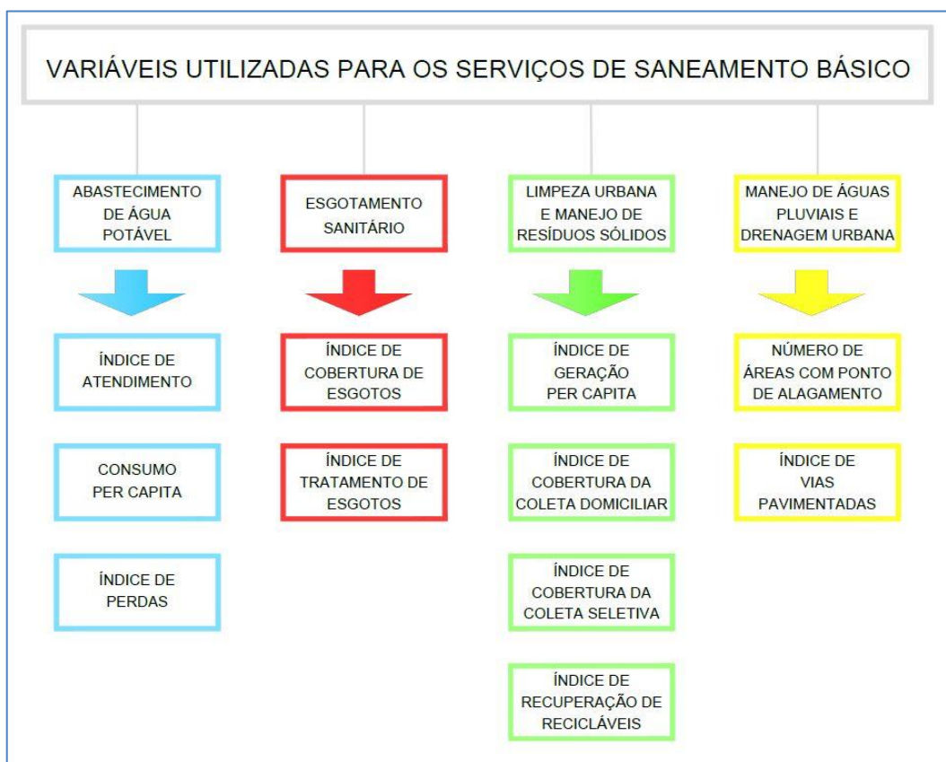
Figura 14 – Variáveis utilizadas para a projeção de cenários dos serviços de saneamento básico.
