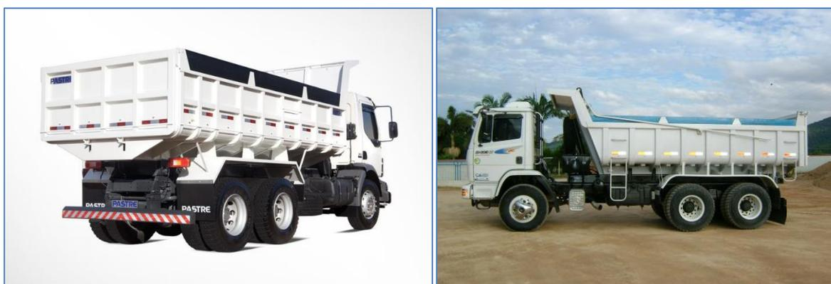
**Figura 54 – Caminhão basculante de 12 m<sup>3</sup>.**
