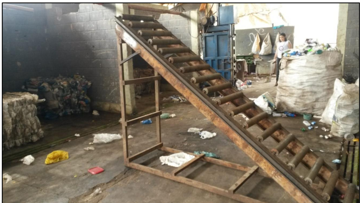
Figura 133: Esteira elevatória na UTC
