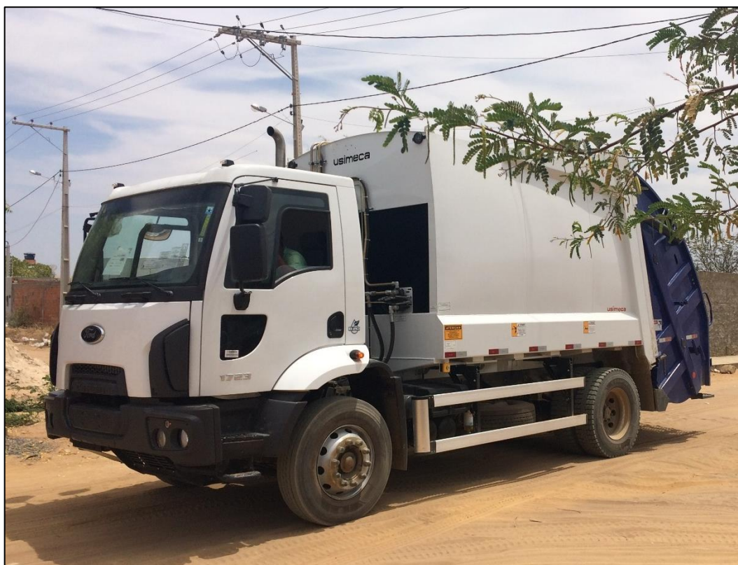
Figura 170 – Caminhão compactador da montadora Ford utilizado na coleta domiciliar do Distrito Sede.
